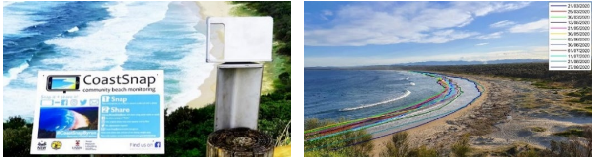
Figure 3 - Gauche : exemple de station CoastSnap en Australie ; droite : extraction de la ligne d'eau sur différentes images permettant de suivre l'évolution de la largeur de la plage dans le temps (© Mitchell Harley)
