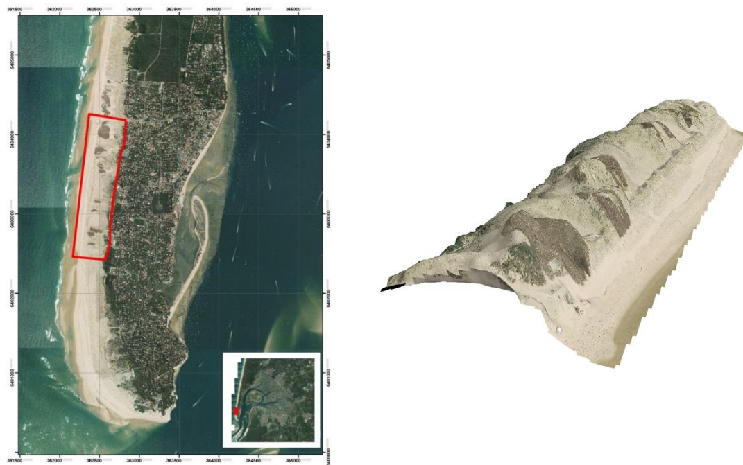
Illustration 3 : Secteur d'étude le long de la flèche du Cap-Ferret et orthophotographie 2016 projetée sur le MNT issu du LiDAR 2016
