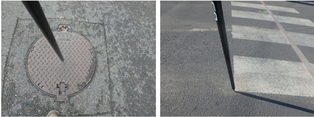
Illustration 3 – Plaque d’égout (Soorts-Hossegor) et bande de passage piéton (Lacanau) permettant de vérifier le calage planimétrique de l’orthophotographie
